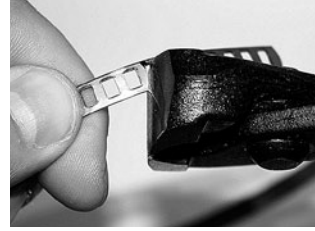
Schritt 3 Übrig bleibendes Material abtrennen. Um mögliche Verletzungen zu vermeiden, Schnittkanten mit Feile entgraten.
