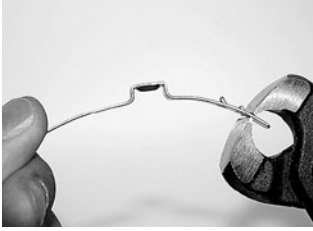
Schritt 1 Klemme vorrunden.
